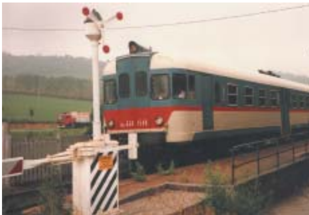
Automotrice Fiat ALn 668 diesel con potenza di 310 CV, 1990
