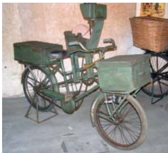
Bicicletta dell'arrotino, attrezzata con la mola installata sulla canna e le cassette con gli attrezzi collocate sui parafranghi.
