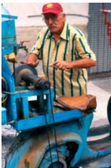
L'attrezzatura dell'arrotino montata sulla parte posteriore di uno scooter Vespa.
